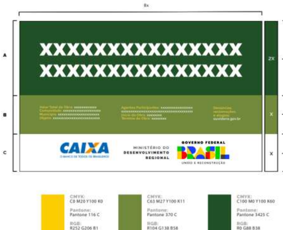
PLACA DE OBRA
