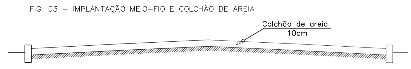
FIG. 03 - IMPLANTAÇÃO MEIO-FIO E COLCHÃO DE AREIA
